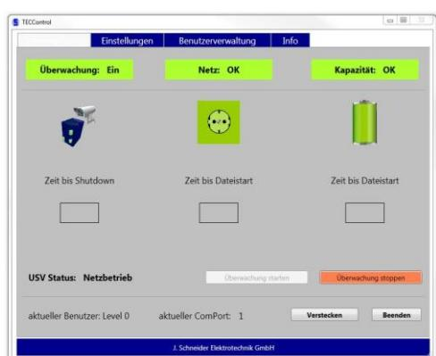
TECCControl-Software automatiserar avstängning i händelse av strömvabrott och kontrollerad omstart av systemet då strömmen är tillbaka. Okontrollerade processtopp undviks.
