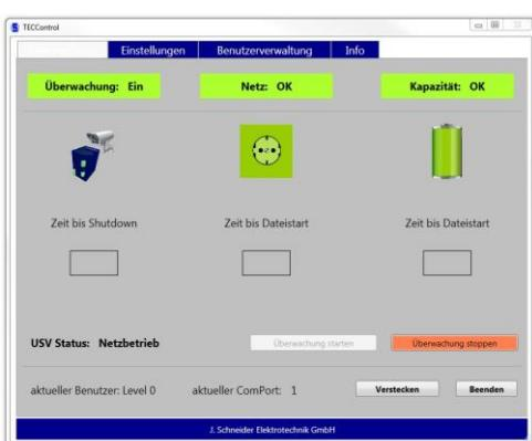
**TECControl**-Software automatatiserar avstängning i händelse av strömavbrott och kontrollerad omstart av systemet då strömmen är tillbaka. Okontrollerade processstopp undviks. Fråga efter mer information.
